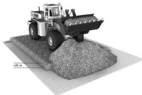
Abb. 6: Einbringen von Schüttmaterial auf Secugrid®
